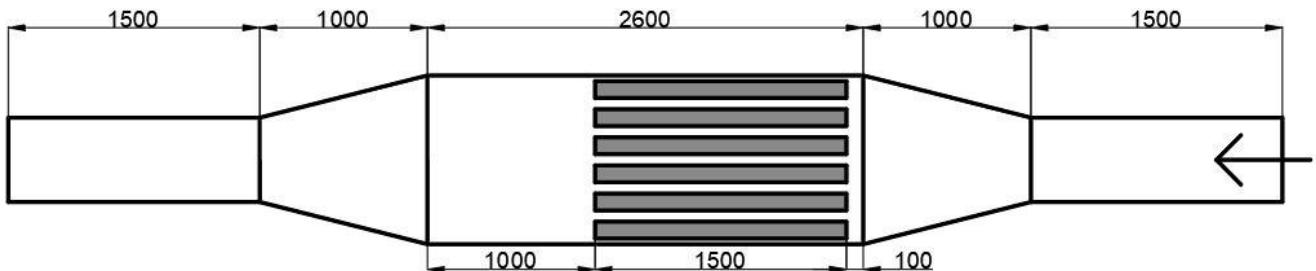
Obr. 4. Pozdĺžny rez modelovaným tlmičom hluku
