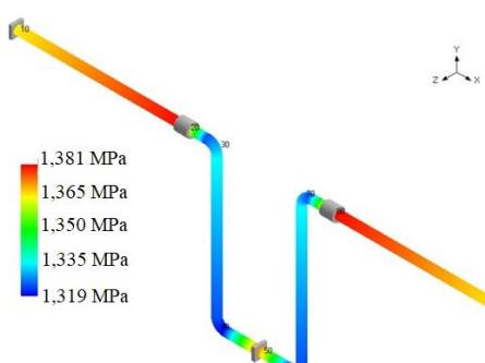
Obr. 7. Rozloženie napäti v potrubí z PE
