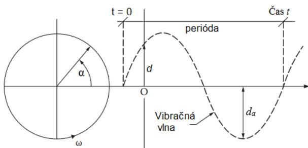
Obr. 1. Schéma vlny vibrácie
