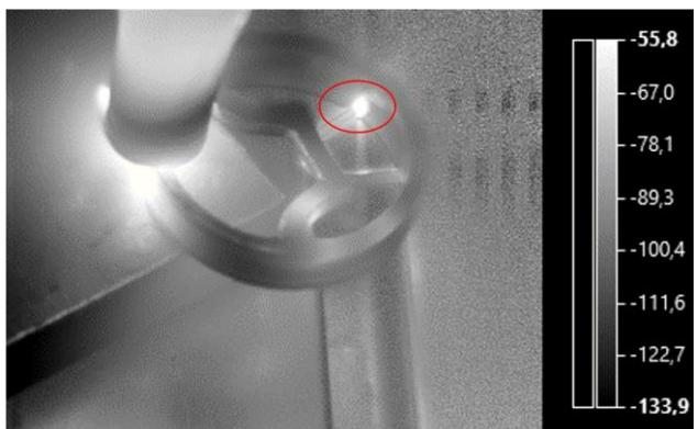
Obr. 6. Tretia vzorka po excitácii, frekvencia excitácie je 0,065 Hz
