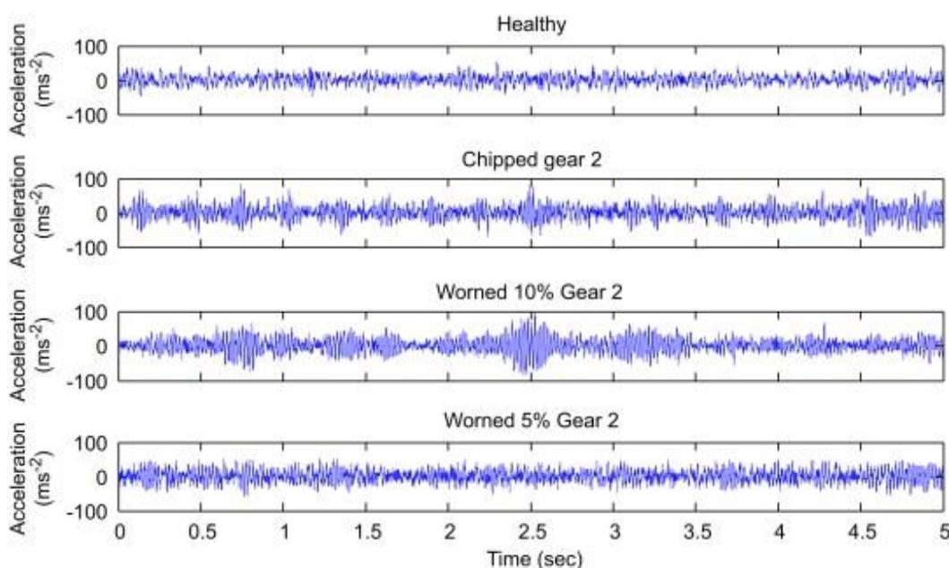
Obr. 2. Názorná ukážka merania vibrácií od ozubených kolies, Healthy – nepoškodené kolesá, Chipped – hlava zuba je poškodená, Worned 10 % - odobratých 0,5 mm hrúbky zuba, Worned 5 % - odobratých 0,3 mm hrúbky zuba [4]
