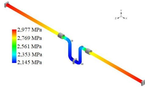
Obr. 8. Rozloženie napäti v potrubí z ocele
