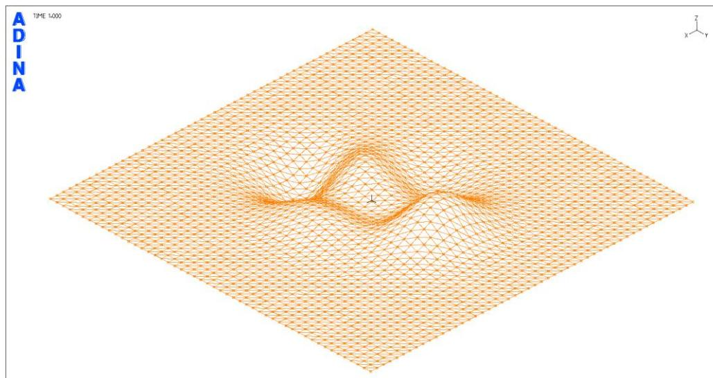
Obr. 3. Vytvorená geometria povrchu zvaru
