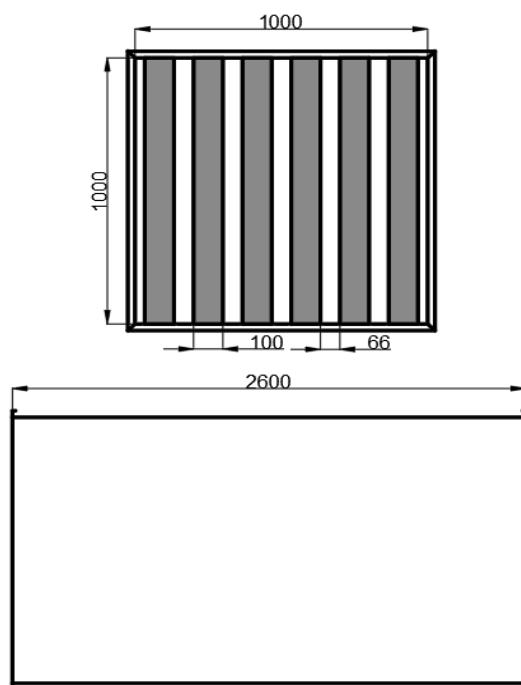
Obr. 2. Priečny rez modelovaným tlmičom hluku
