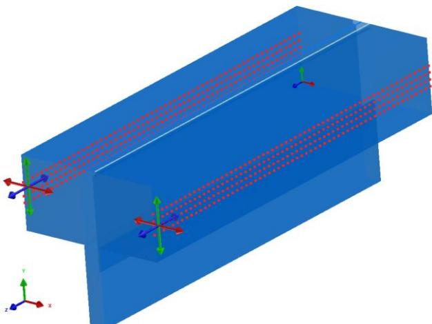
Obr. 2. Uchytanie zvarového spoja počas prvých 200 s zvárania
