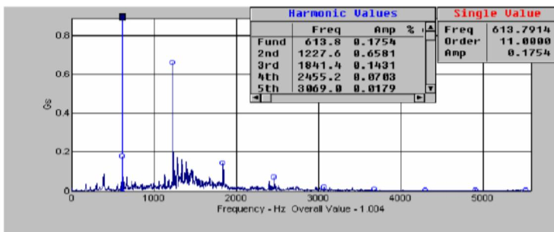
Obr. 3. Ukážka merania vibrácií na použitej prevodovke [5]
