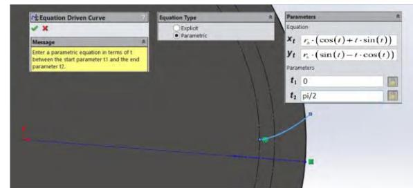
Obr. 8. Parametrické modelovanie evolventy
