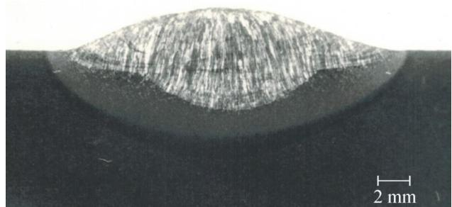
Obr. 2. Makroštruktúra návaru [5]
