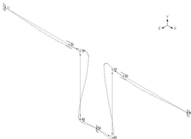
**Obr. 5. Dilatácia potrubného úseku**
