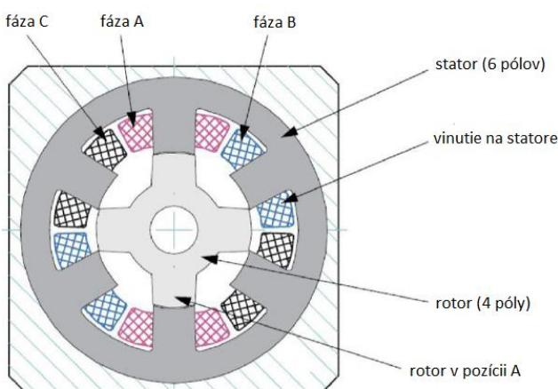
Obr. 4. Schéma reluktančného motora [12]
