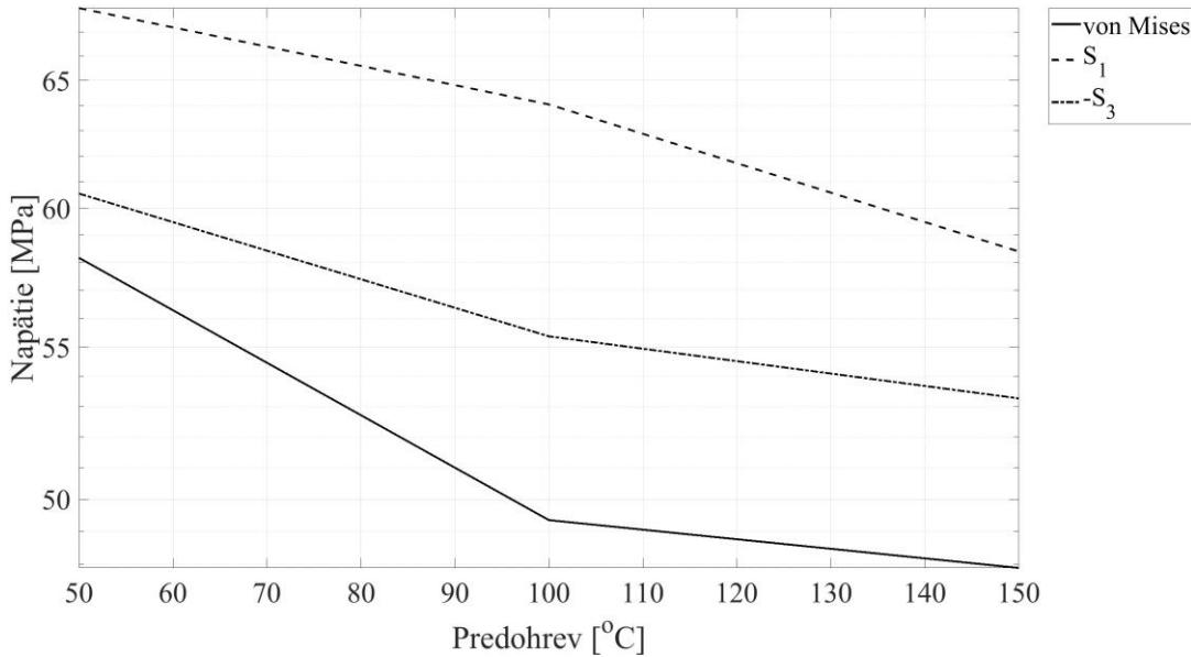
Obr. 8. Vplyv teploty predohrevu zvarenca na hodnoty zvyškových napäťí
