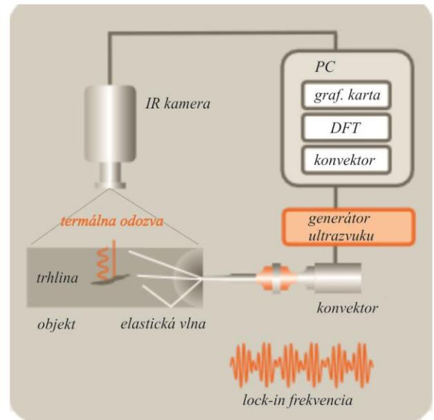
Obr. 1. Schematické znázornenie principu UTVIS, skratka DST znamená diskrétna Fourierova transformácia [19]
