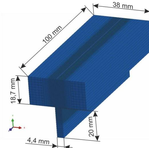
Obr. 1. Geometria simulovaného zvarového spoja typu  $T$
