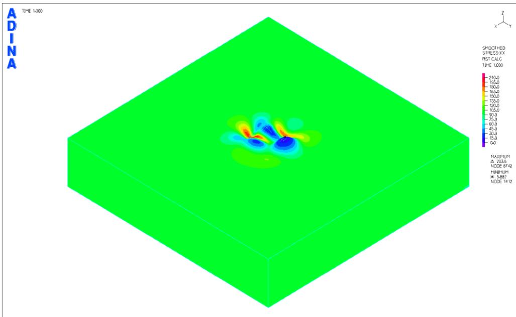
Obr. 5. Rozloženie napäti v smere zaťaženia v smere osi x
