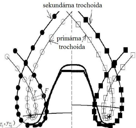
Obr. 2 Schéma prechodových kriviek [8]
