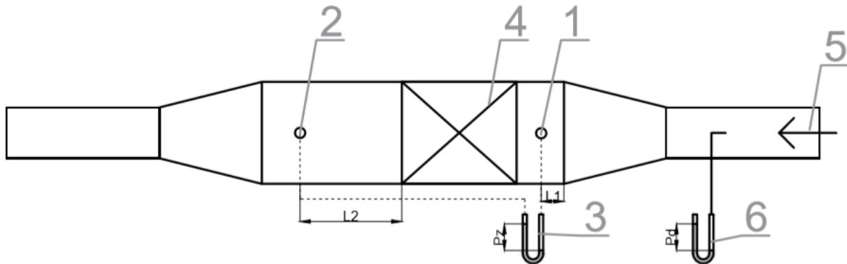
Obr. 5. Schéma merania tlakovej straty podľa STN EN ISO 7235 (1-meranie statického tlaku proti prúdeniu pred skúšaným objektom, 2-meranie statického tlaku po prúde za skúšaným objektom, 3-manometr, 4-kulisový tlmič, 5-smer prúdenia, 6- meranie prietoku)
