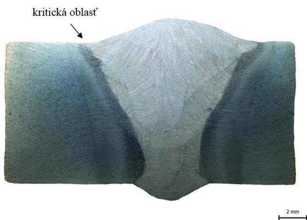
Obr. 1. Oblast' nepriaznivého tvaru zvaru
