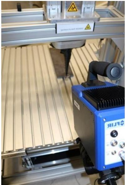
Obr. 3. Proces záznamu infračervenej kamery na excitáciu vzorky
