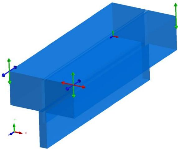
Obr. 3. Uchytenie zvarového spoja v časovom intervale 200 – 7200 s (do vychladnutia)
