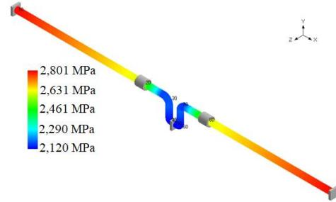
Obr. 9. Rozloženie napäti v potrubí z medi
