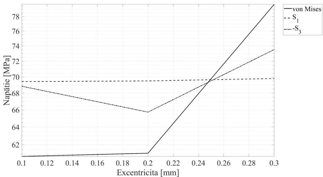
Obr. 6. Vplyv excentricity na hodnoty zvyškových napäťí zvarenia
