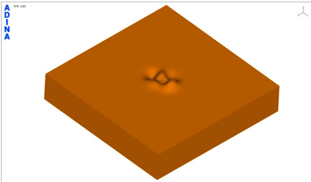
Obr. 4. Geometrický model zvarového spoja s geometriou povrchu zvaru
