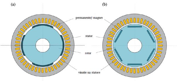
Obr. 2. Priečny rez motorov s permanentnými magnetmi (rôzne uloženia magnetu) (a) permanentné magnety na povrchu rotora, (b) permanentné magnety vo vnútri rotora [7]
