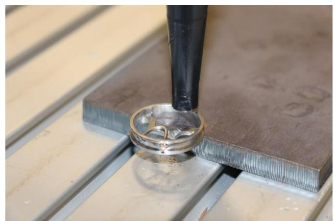
Obr. 2. Vzorka pod ultrazvukovým budičom
