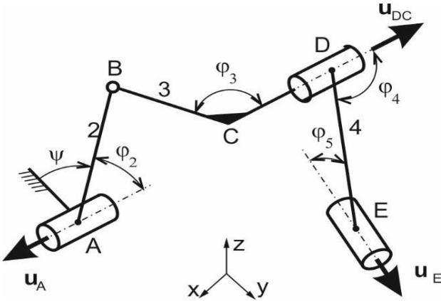
Obr. 1. Trojrozmerný štvorčlenný mechanizmus RSCR
