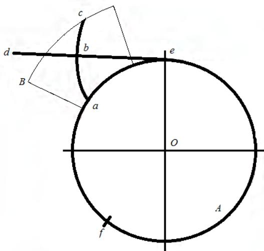
Obr. 1 Schéma tvorby evolventy
