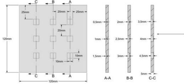
Obr. 1. Rozmery skúšobnej vzorky
