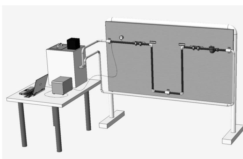
Obr. 2. 3D model experimentálneho zariadenia – „U“ kompenzátor
