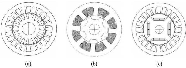
Obr. 1. Najpoužívanejšie elektromotory (a) indukčný motor (b) reluktančný motor (c) synchrónny motor s permanentnými magnetmi [3]
