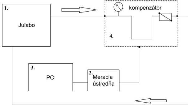
Obr. 1. Bloková schéma experimentálneho zariadenia
