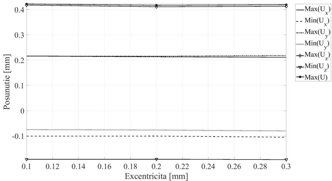
Obr. 5. Vplyv excentricity na posunutia bodov zvarenia
