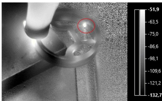
Obr. 4. Prvá vzorka po excitácii, frekvencia excitácie je 0,03 Hz
