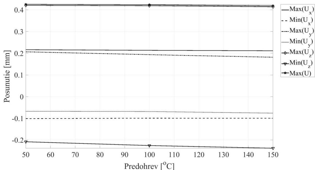
Obr. 7. Vplyv teploty preohrevu zvarenia na posunutia bodov
